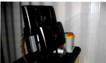
Questa immagine ci mostra il rack in acciaio descritto nell'articolo. Grazie a questa struttura è stato possibile inserire gli amplificatori, la batteria, il condensatore e il distributore di tensione in un insieme facilmente rimovibile in caso di necessità.
