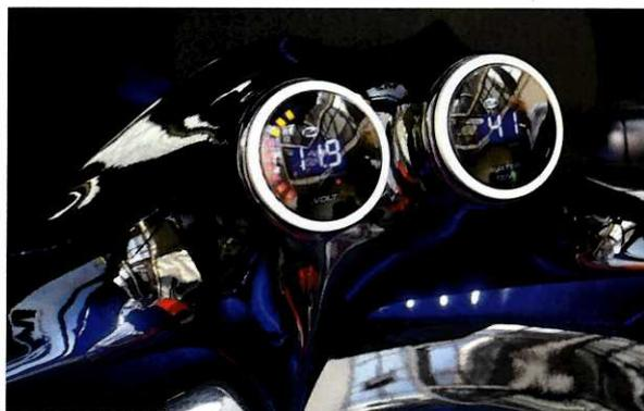
L'impianto va tenuto sotto controllo. Ecco due strumenti che fanno al caso. Lo stato della temperatura degli amplificatori e la loro tensione di alimentazione sono sempre sotto gli occhi del proprietario, specialmente quando l'auto è in mostra.
