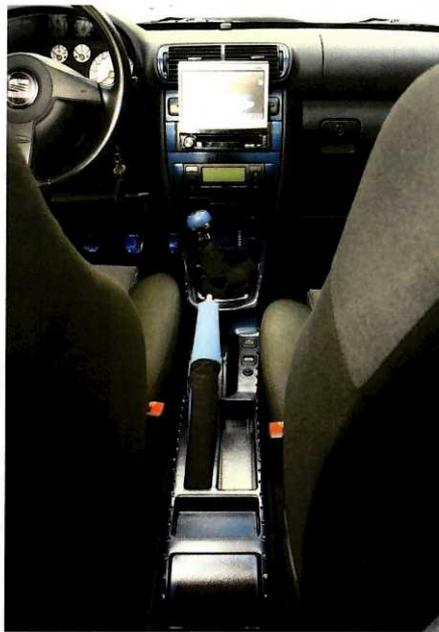
La sorgente Alpine è l'unico componente dell'impianto installato "in predisposizione". Intorno a lui, però, si nota il lavoro dell'installatore che ha operato nel tunnel centrale per rendere meno "banale" la struttura. Lo ha fatto pitturando di un bel blu metallizzato il tutto e inserendo parte dei circa 940 led usati nell'abitacolo per ottenere la particolare illuminazione.
