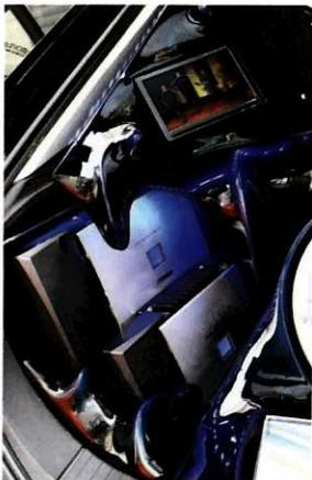
Il bagagliaio della Leon è davvero scenografico. In questo particolare si notano i baffi con valore solo estetico di uno dei supporti in resina realizzati a mano per inserire i vari componenti dell'impianto. Gli amplificatori Alpine sono stati montati su un rack in acciaio che li tiene in posizione e permette di accogliere, ben nascosta, la batteria Optima.
