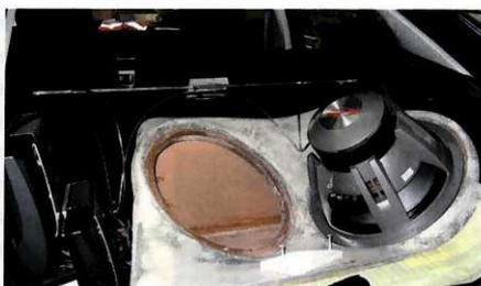
Ecco un primo abbozzo del posizionamento dei vari componenti nel bagagliaio. Sopra alla struttura del sub si nota la rete metallica che servirà da manichino per realizzare il supporto dei monitor e dei misuratori, che andrà a sovrapporsi ai sub e agli amplificatori.
