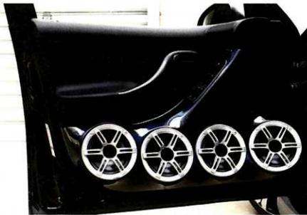
Una completa ricostruzione del pannello porta, realizzato in MDF e vetroresina, ha permesso l'installazione di questa batteria di woofer Hertz da 16 cm. L'orientamento dei trasduttori è studiato per distribuirne l'irradiazione nell'abitacolo.
