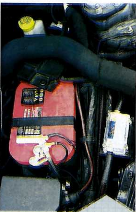
La batteria Optima espressamente dedicata ai sistemi Car Hi Fi che hanno bisogno dello spunto elevato per favorire il funzionamento degli amplificatori.
