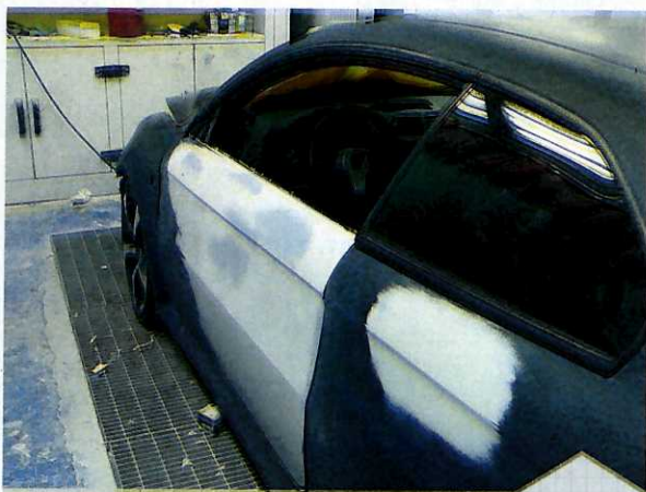
La fase della lavorazione della carrozzeria nella quale viene chiusa l'area della maniglia.
