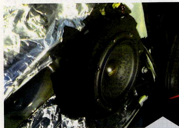
Una vista del lavoro svolto sulla portiera per insonorizzarla e collocare correttamente il trasduttore della ESB.
