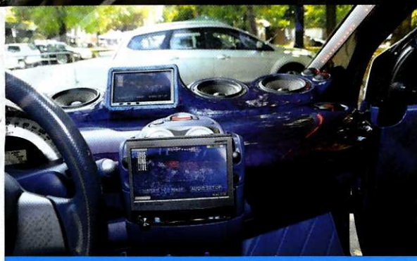
La sorgente Alpine IVA-D310R inserita nella originaria predisposizione e subito sopra il monitor JVC da 7", incastonato nella struttura in resina che posiziona anche gli altoparlanti.
