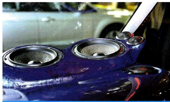
Sul cruscotto dell'auto si trovano altri due midwoofer da 16 cm, una coppia di tweeter al neodimio da 25 mm di diametro e il midrange ESB DM8.50.
