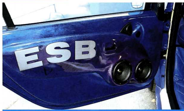
Il pannello porta della Smart, completamente ricostruito in vetroresina ed MDF, ospita due dei quattro midwoofer ESB previsti dallo schema dell'impianto per ciascun canale.
