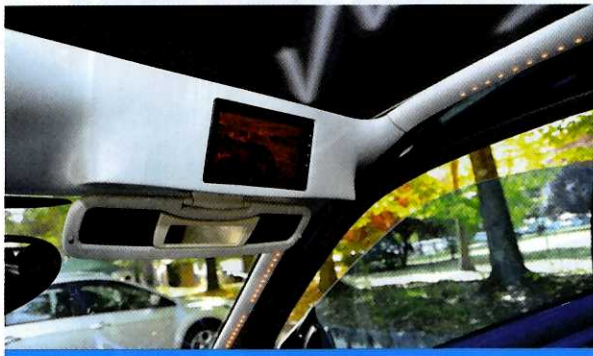
La coppia di monitor LCD della JVC da 5" è stata collocata sopra le alette parasole della vettura, grazie ad un supporto in vetroresina costruito dall'installatore.
