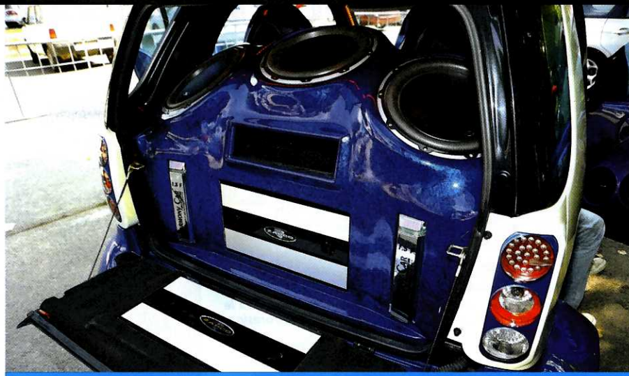
Seppur piccolo, il bagagliaio della Smart ospita il poderoso subwoofer realizzato con ben tre trasduttori JL Audio da 32 cm di diametro. L'amplificatore per il sistema anteriore è stato inserito nella ribaltina posteriore.
